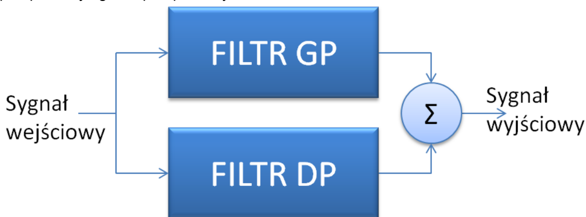
Rys 5. Równoległe łączenie filtrów
