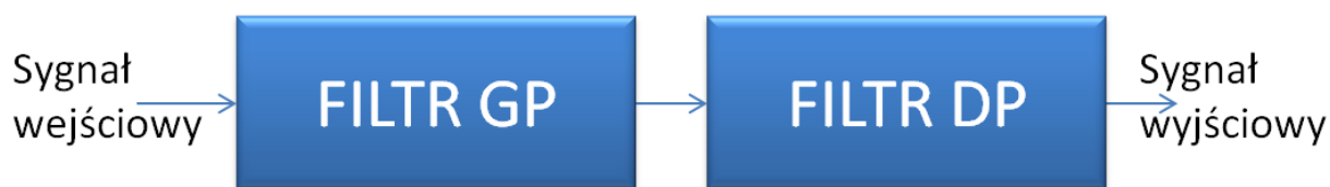
Rys 6. Szeregowe łączenie filtrów
